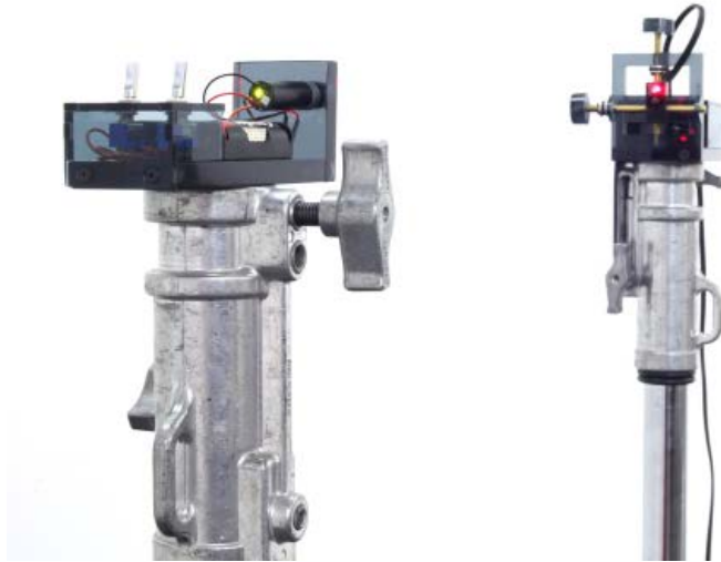
Material: 2 Acrylglas-konsolen, Laser, Lichtsensor, Elektronik, Lautsprecher oder Kopfhörer Stativkopf Maße pro Objekt : 20 cm x 15cm x 7 cm
